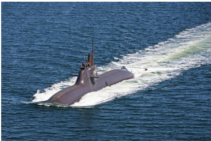
U-212 (Германия) – подводная лодка, автономность до 30 суток, ПОМТЭ+АКБ 1700 кВт
