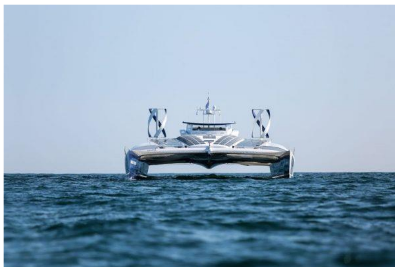
Energy Observer (Франция) – НИС 30 метров, АКБ + ПОМТЭ + солнечные панели + ветротурбины
