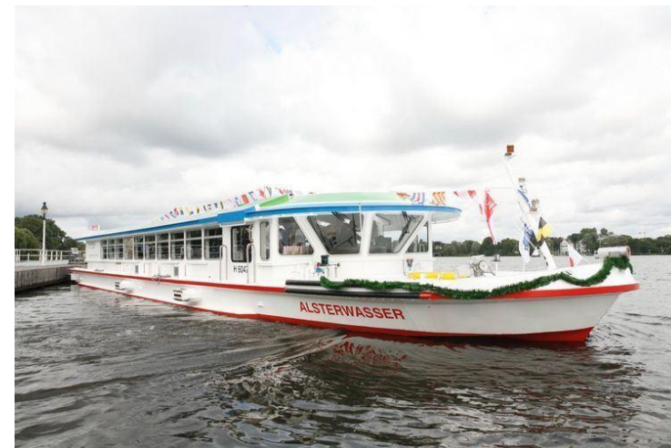
Zemships (Германия) – речной паром на 100 пассажиров, ПОМТЭ+АКБ 100 кВт
